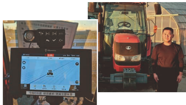
五霞地区 杉田陽一さん 後付け自動操舵システム導入 主な作物 水稻・人参・ねぎ
